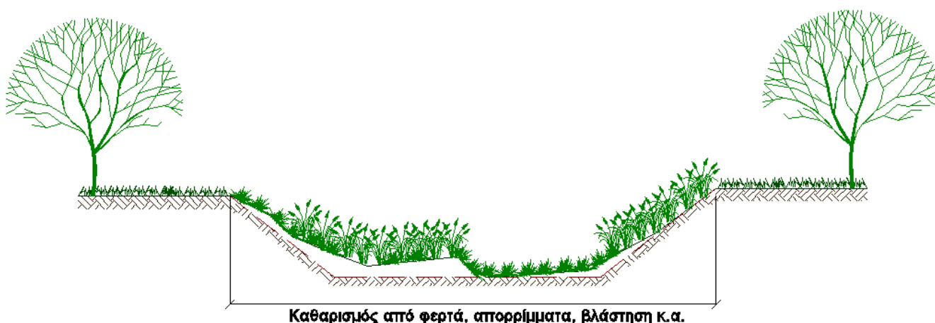
Σχήμα 4.3: Εργασίες καθαρισμού σε τμήματα με συσσώρευση φερτών υλών (Το σχήμα είναι άνευ κλίμακας)
